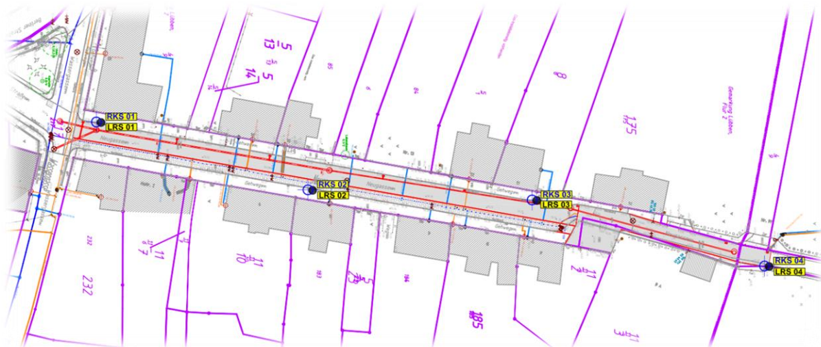
Abbildung 2: Lage der Baugrundaufschlüsse Zuwegung
